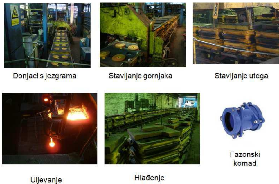
Slika 34. Djelovi automatske kalupne linije
